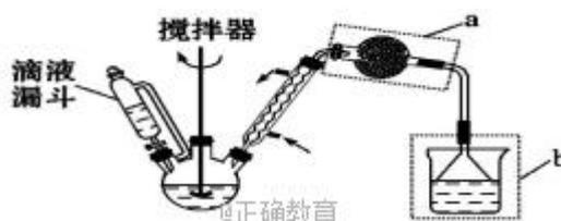
(I) 合成：在三颈瓶中加入 20 g 无水三氯化铝和 30 mL 无水苯。为避免反应液升温过快，边搅拌边慢慢滴加 10.2 mL 乙酸酐和 15.2 mL 无水苯的混合液，控制滴加速率，使反应液缓缓回流。滴加完毕后加热回流 1 小时。已知：
